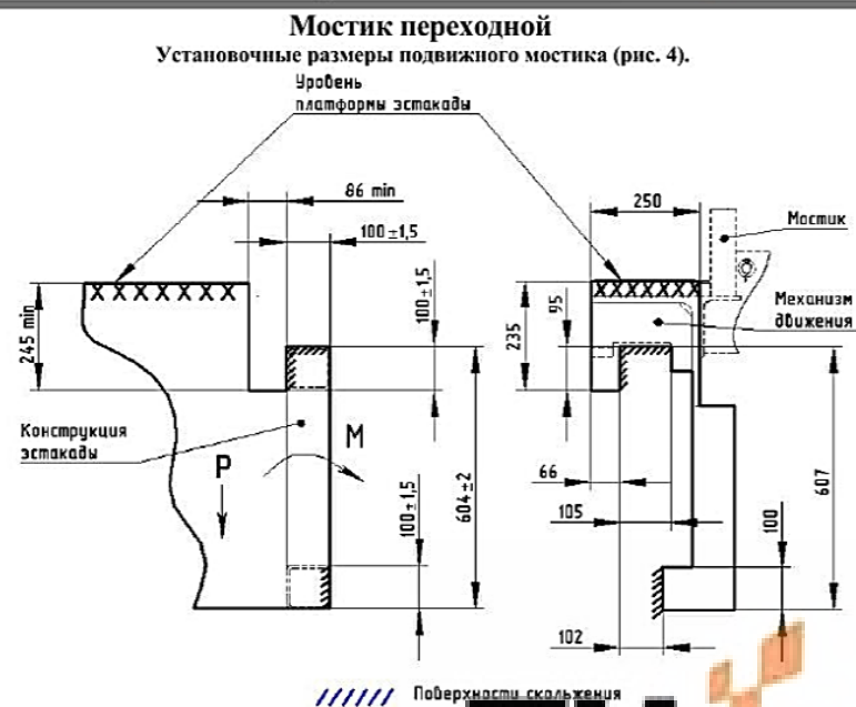
Рис. 4. Установочные размеры подвижного мостика.
