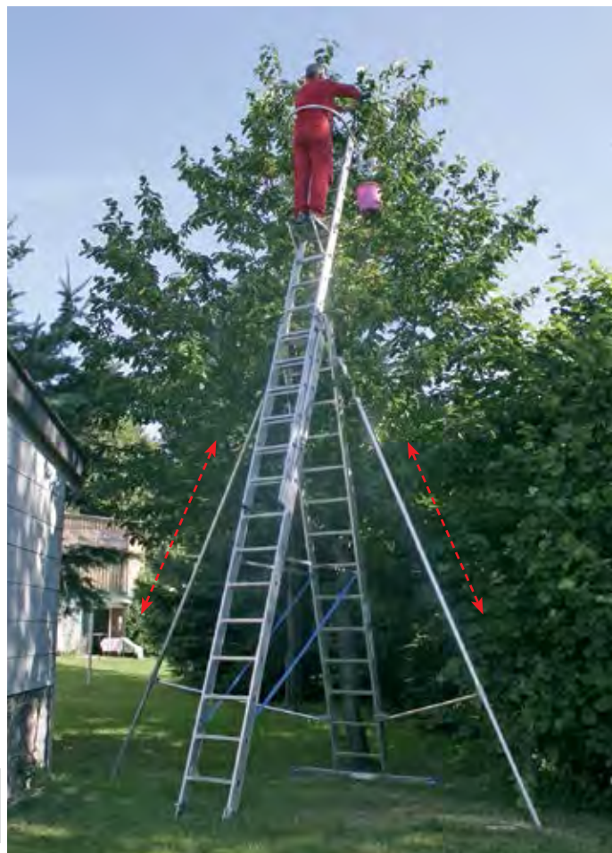
Фрагмент стабилизирующей опоры для приставных лестниц и лестниц-стремянков (поворотный тип)
